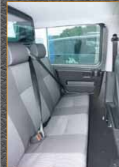
Wandverkleidung ABS mit Fensterrahmen und vorgeformter Himmelverkleidung
