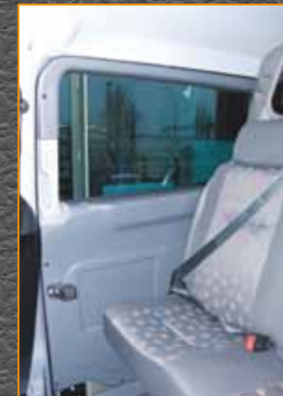
Schiebetürverkleidung ABS mit Fensterrahmen und vorgeformter Himmelverkleidung
